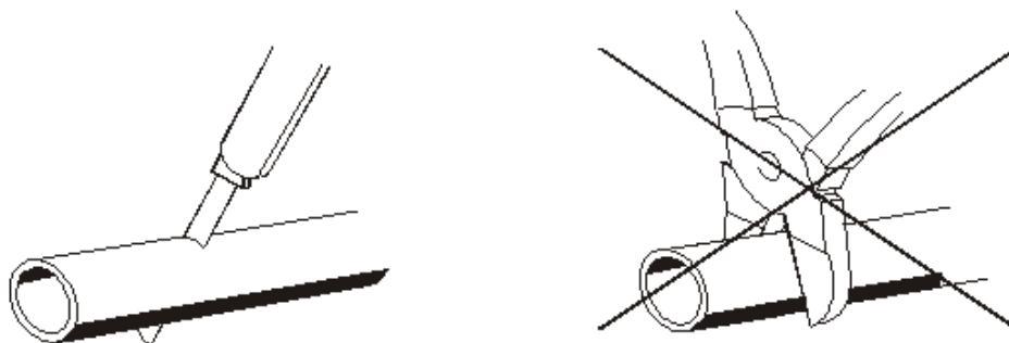
Рис. 8.8 – Отрезка трубопровода перед установкой.
