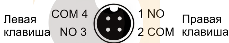
Рисунок 4 – Разъем для подключения контроллера CARVIS ZP-01
